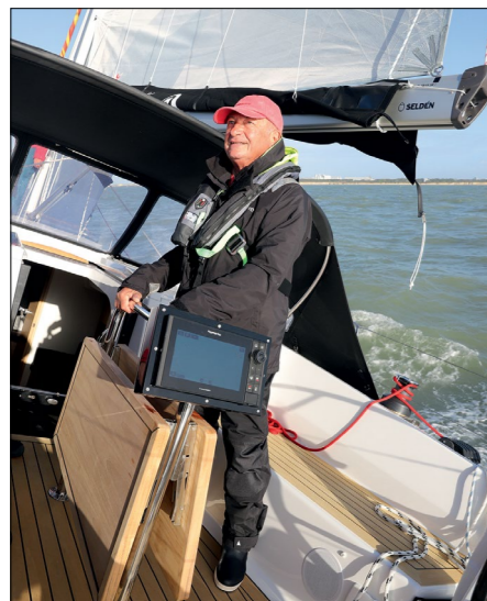
▲ L'arceau inox de la table, solidement implanté dans le cockpit, offre un appui très sûr.
